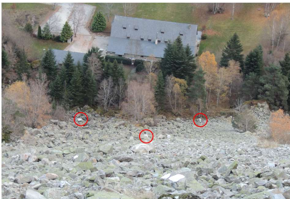
Figura 15. Detall de la part distal de la tartera, on s'observen alguns dels blocs molt recents inventariats.
