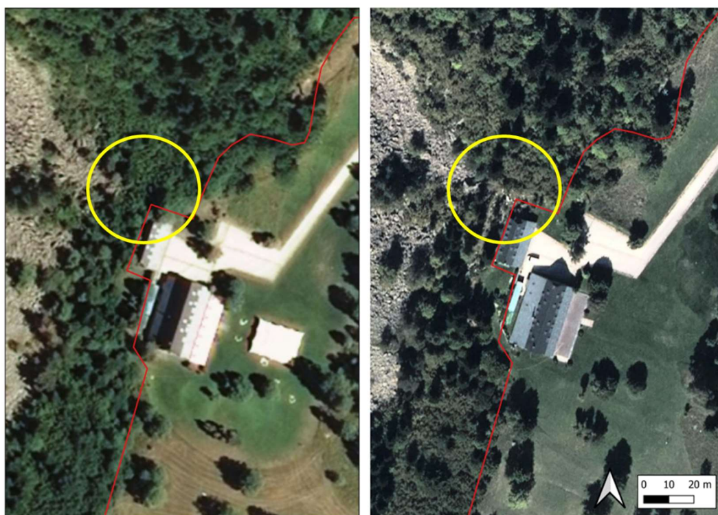
Figura 32. Danys a la vegetació causats per un desprendiment entre l'estiu de 2016 i l'estiu de 2017.
