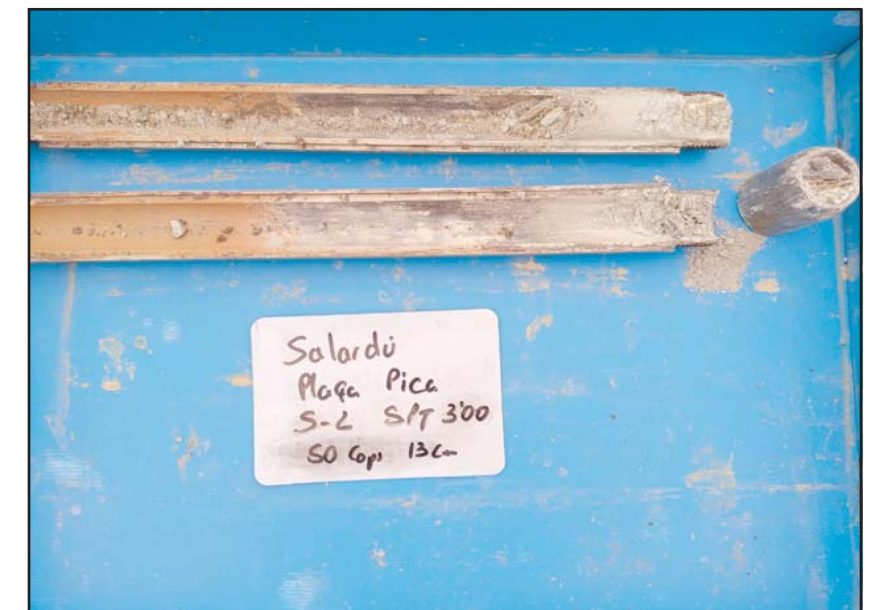
Fotografia 6. Detall dels materials recuperats de l'assaig SPT-2.
