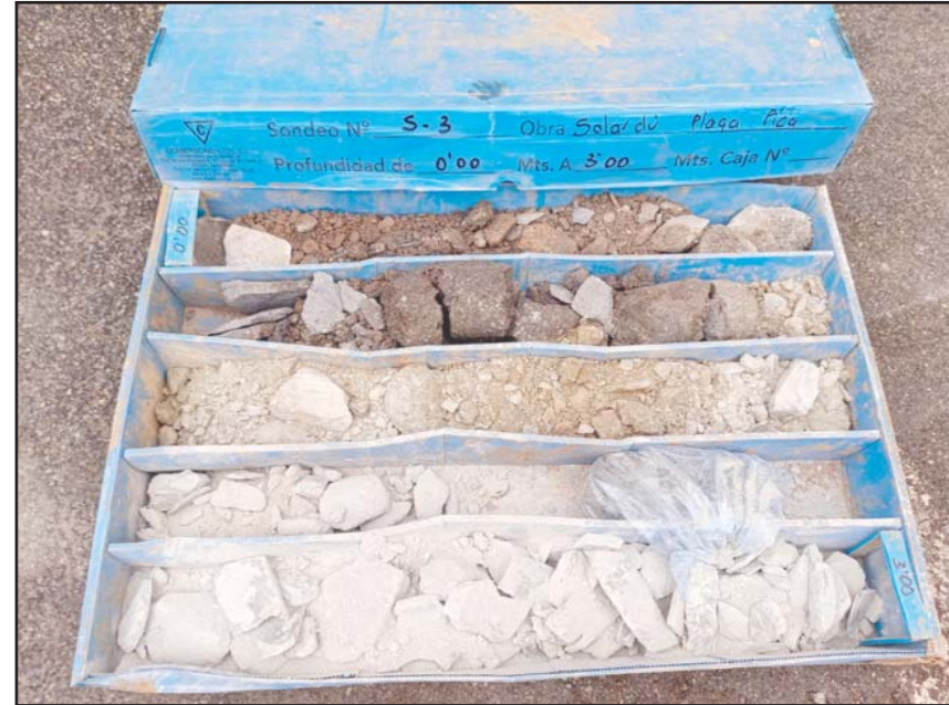
Fotografia 2. Detall dels materials recuperats en el sondeig S-3, de 0 a 3.0 metres.
