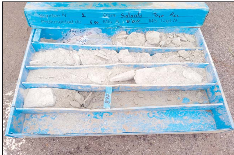
Fotografia 4. Detall dels materials recuperats en el sondeig S-1, de 6.0 a 8.0 metres.
