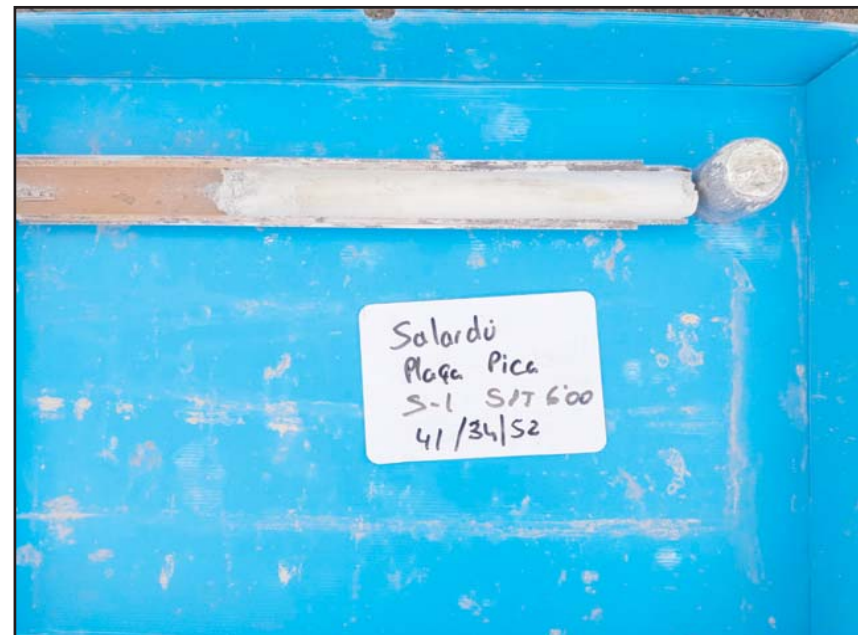
Fotografia 5. Detall dels materials recuperats de l'assaig SPT-2.
