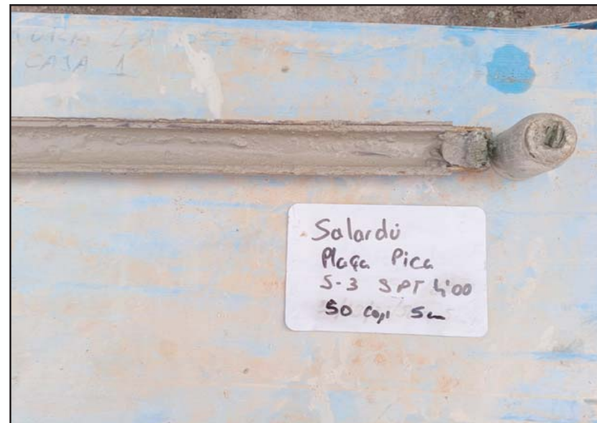
Fotografia 6. Detall dels materials recuperats de l'assaig SPT-2.
