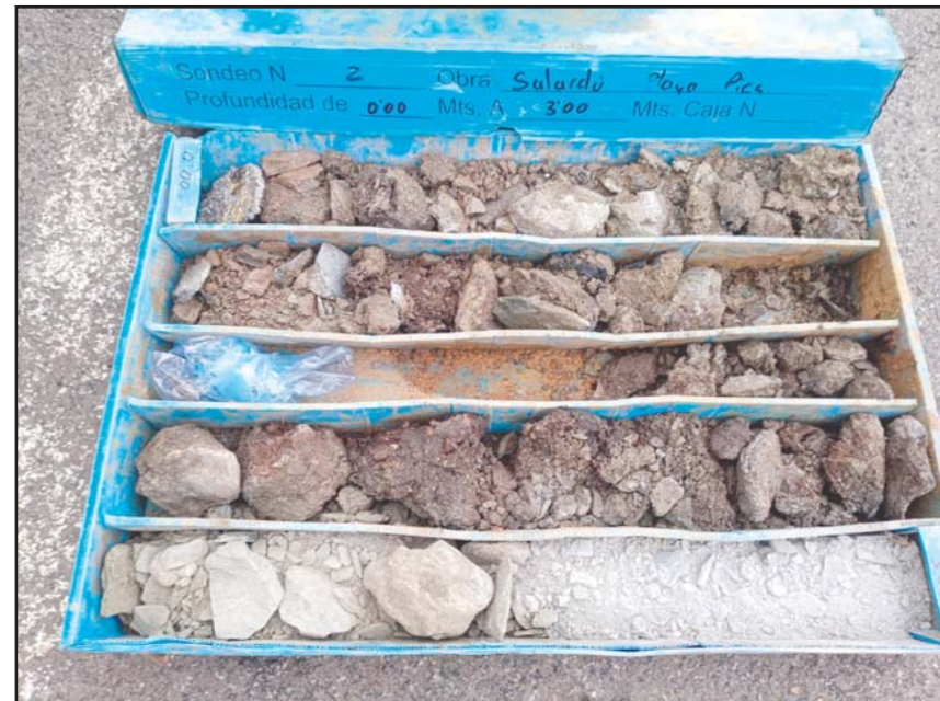
Fotografia 2. Detall dels materials recuperats en el sondeig S-2, de 0 a 3.0 metres.
