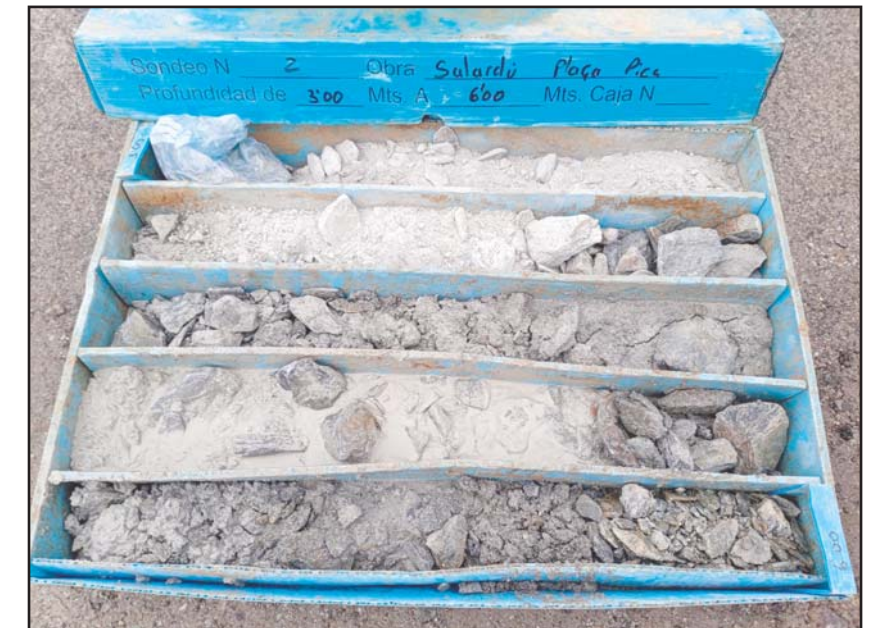
Fotografia 3. Detall dels materials recuperats en el sondeig S-2, de 3.0 a 6.0 metres.
