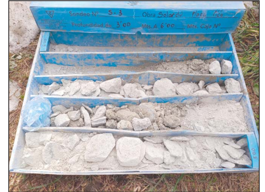
Fotografia 3. Detall dels materials recuperats en el sondeig S-3, de 3.0 a 5.0 metres.
