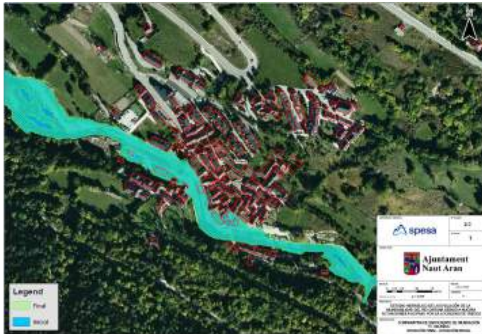
Comparativa zona Inundable T=100 SNCZI (inicial) y obtenida en el estudio (final)
